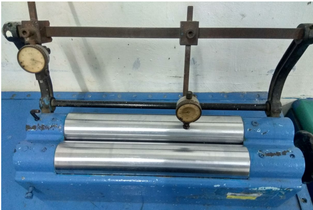
Lampiran 12 Dial Gauge untuk cek top roll eksentrik
