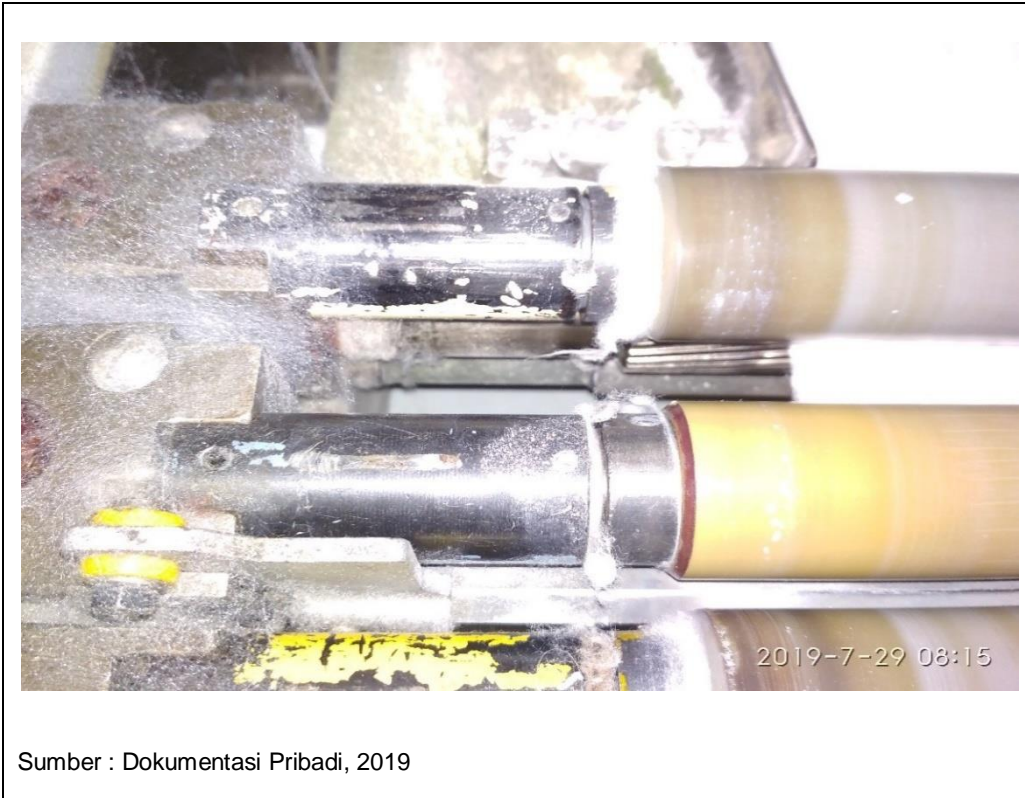
Lampiran 9 Gambar jarak housing top roll dengan Breaket
