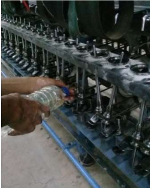
Lampiran 6 Pemberian Oli pada Spindle
