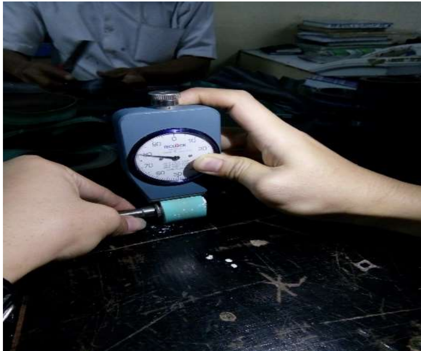
Lampiran 3 Alat Hardnes Tester untuk mengecek kekerasan Top roll
