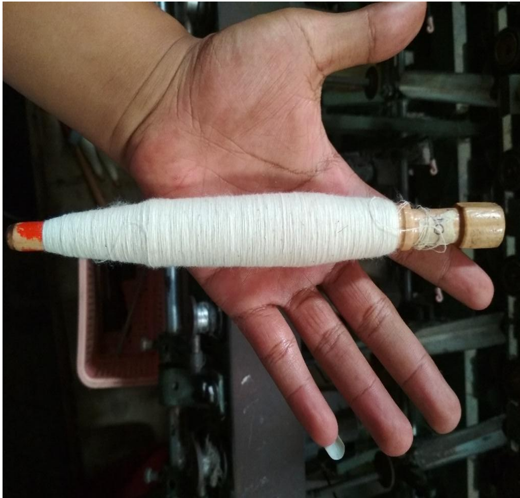
Lampiran 6. Pengecekan Diameter Gulungan PaLampiran 7 Hasil Gulungan Palet Mesin Pirn Winder merk TiongFu
