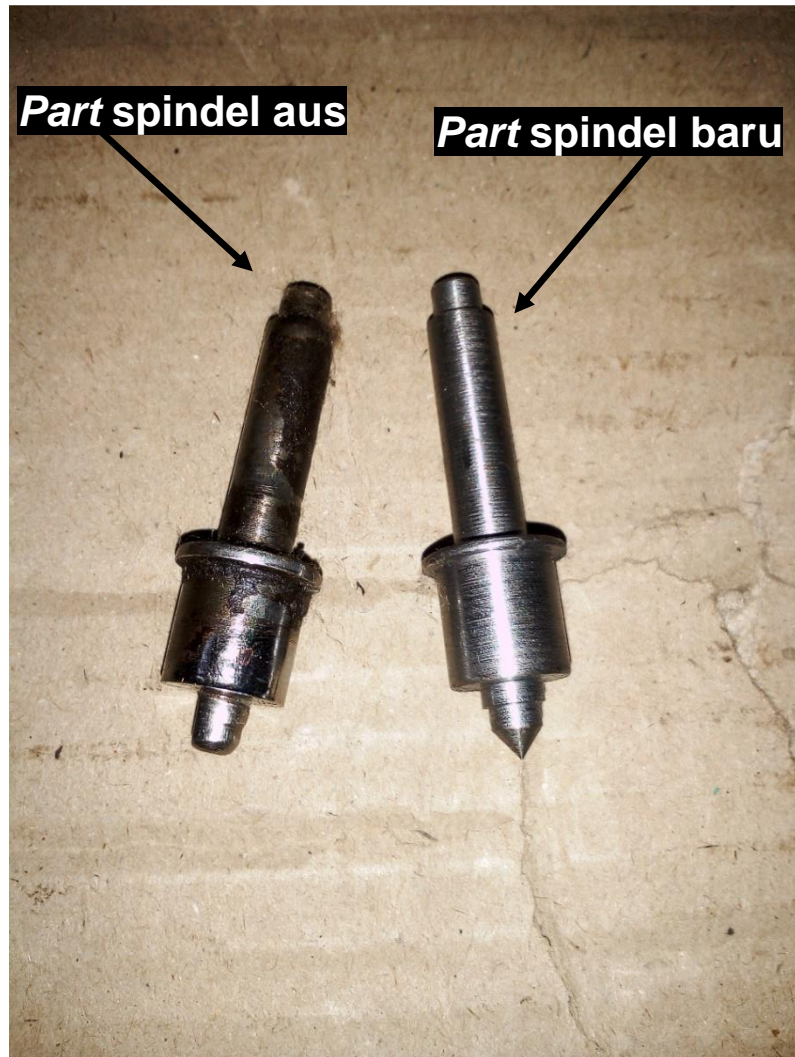
Lampiran 15 Kondisi part spindel aus dan baru
