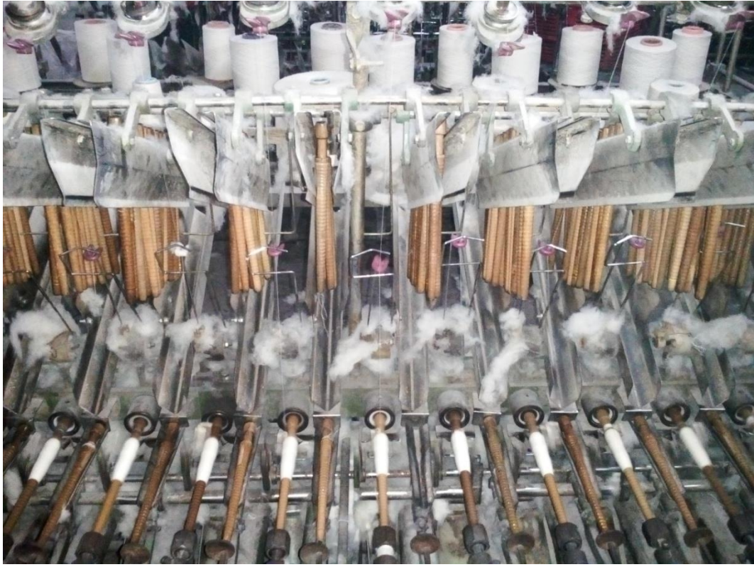
Lampiran 18 Kondisi kebersihan mesin yang kurang
