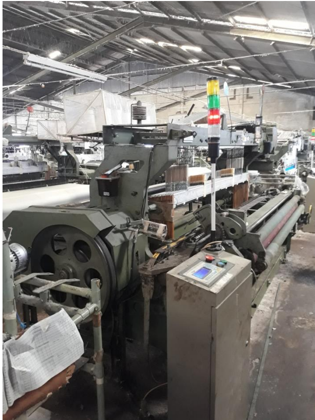
Lampiran 3. Mesin rapier untuk proses konstruksi C160 9448 AAR
