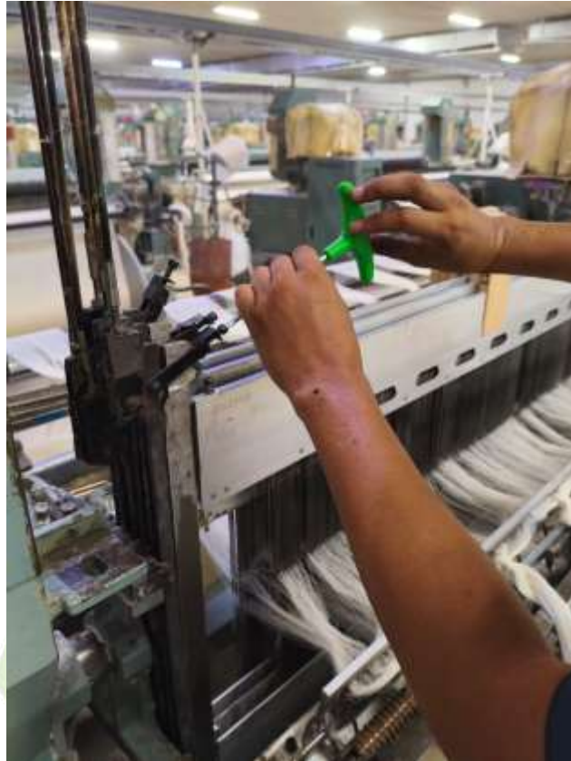
lampiran 7 Pengencangan baut lateral dengan T5
