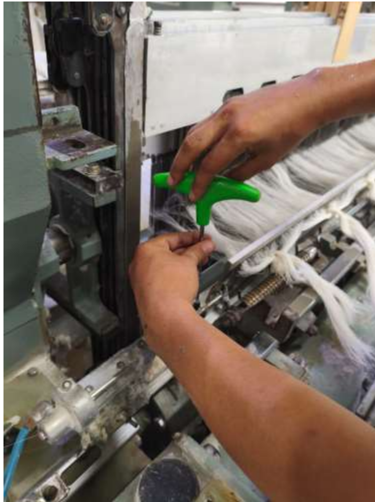
lampiran 6 pengencangan baut sisir dengan kunci T5
