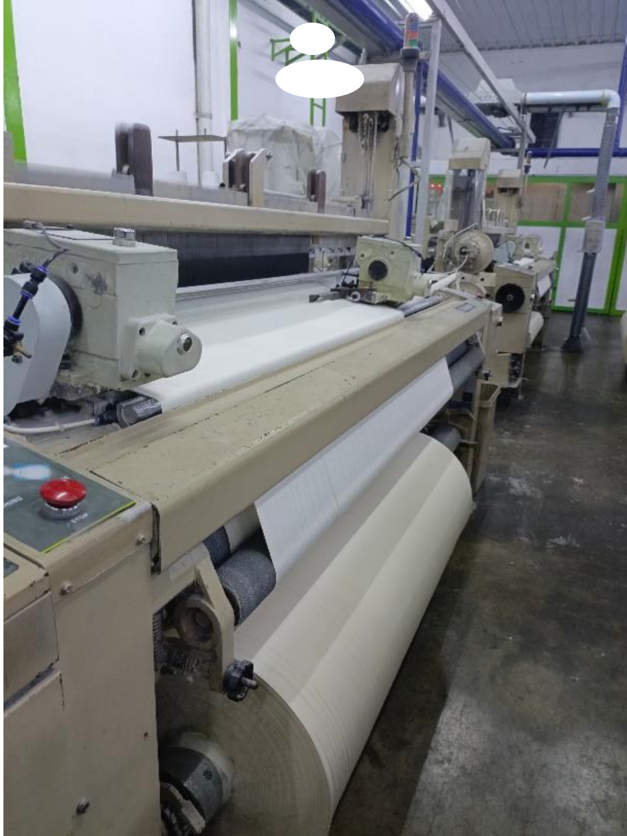
Lampiran 1 Mesin AJL dengan komponen tucking in
