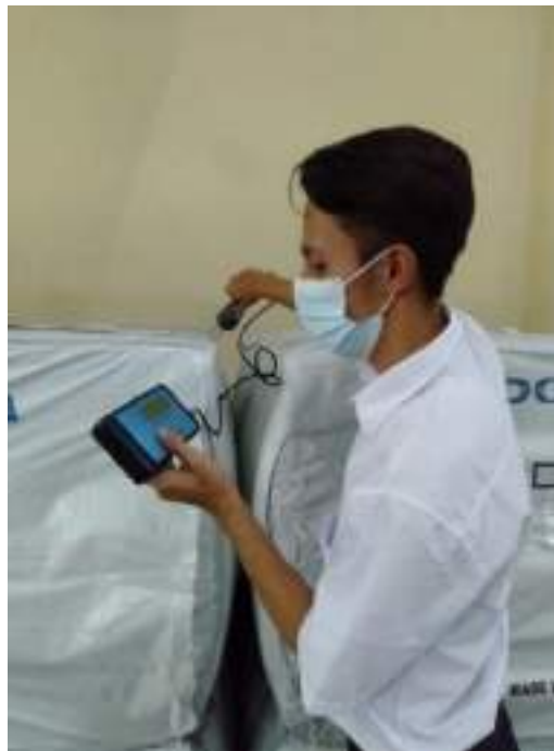
Lampiran 6 Pengecekan Material dengan Alat Uji Aqua Boy
