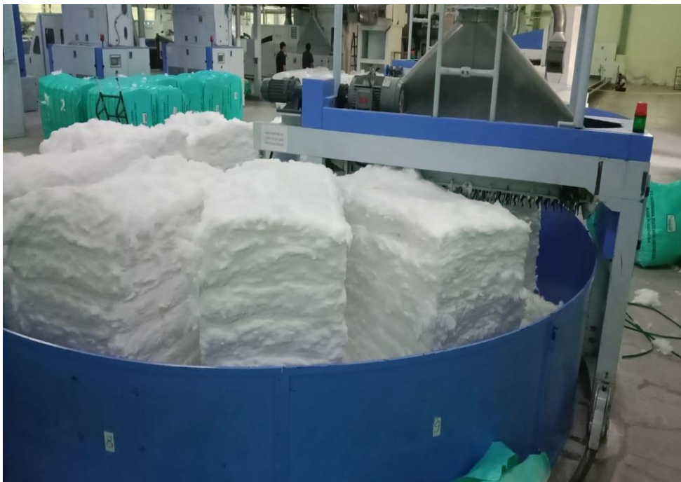
Lampiran 4 Pemasangan Material Reuse Waste Pada Mesin Plucker
