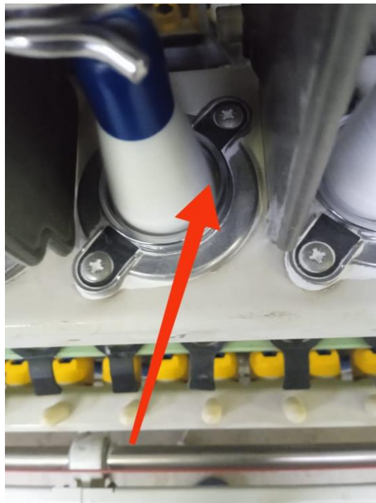
Lampiran 6 Spindle tidak center
