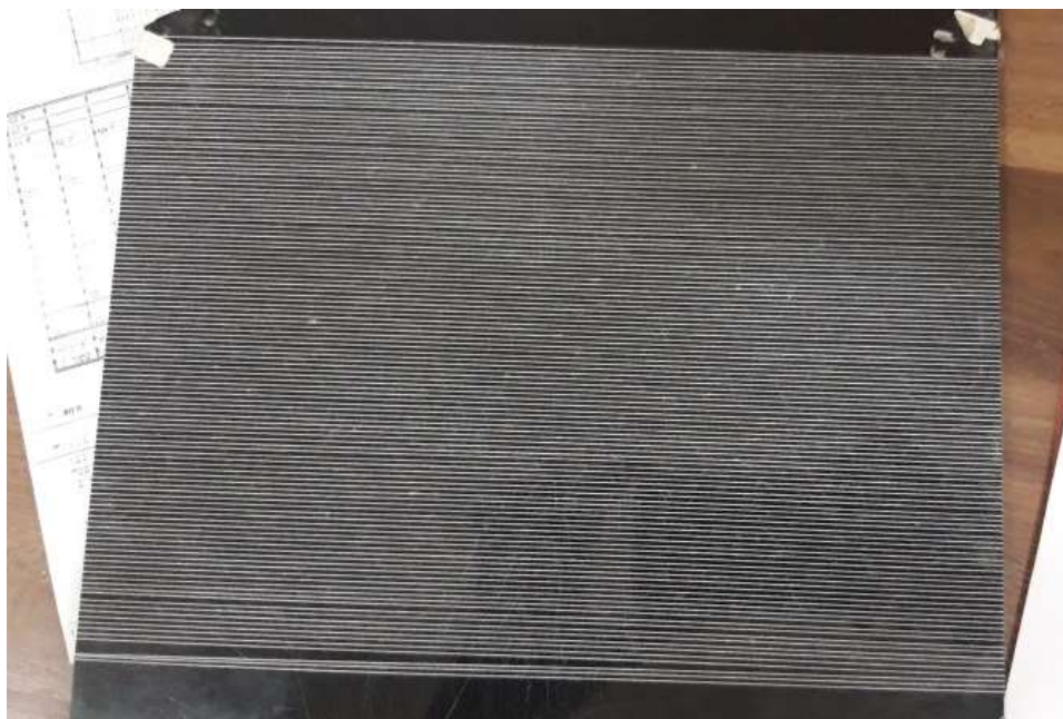
Lampiran 1. 6 Hasil Uji Planofil Benang yang Apronnya Bagus
