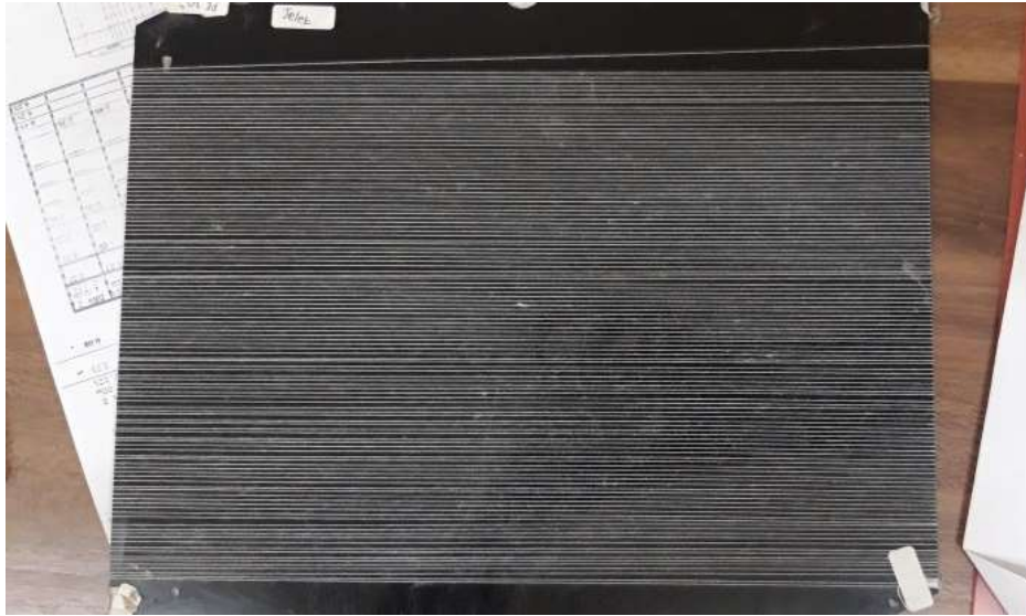
Lampiran 1. 5 Hasil Uji Planofil Benang yang Apronnya Rusak
