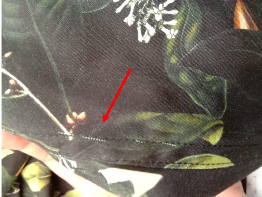
Lampiran 2 Defect Needle Pulls Pada Kemeja Moss Viscose Shirt Autumn Botanical
